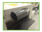
Аспирация Аспирационный патрубок диаметром 140 мм для удаления стружки.
