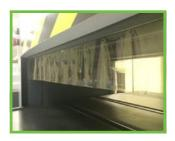
Защитные шторки Предотвращают разброс стружки от станка.
