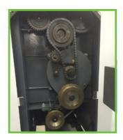
Привод подающих вальцов Осуществляется посредством цепной и шестеренчатой передачи.
